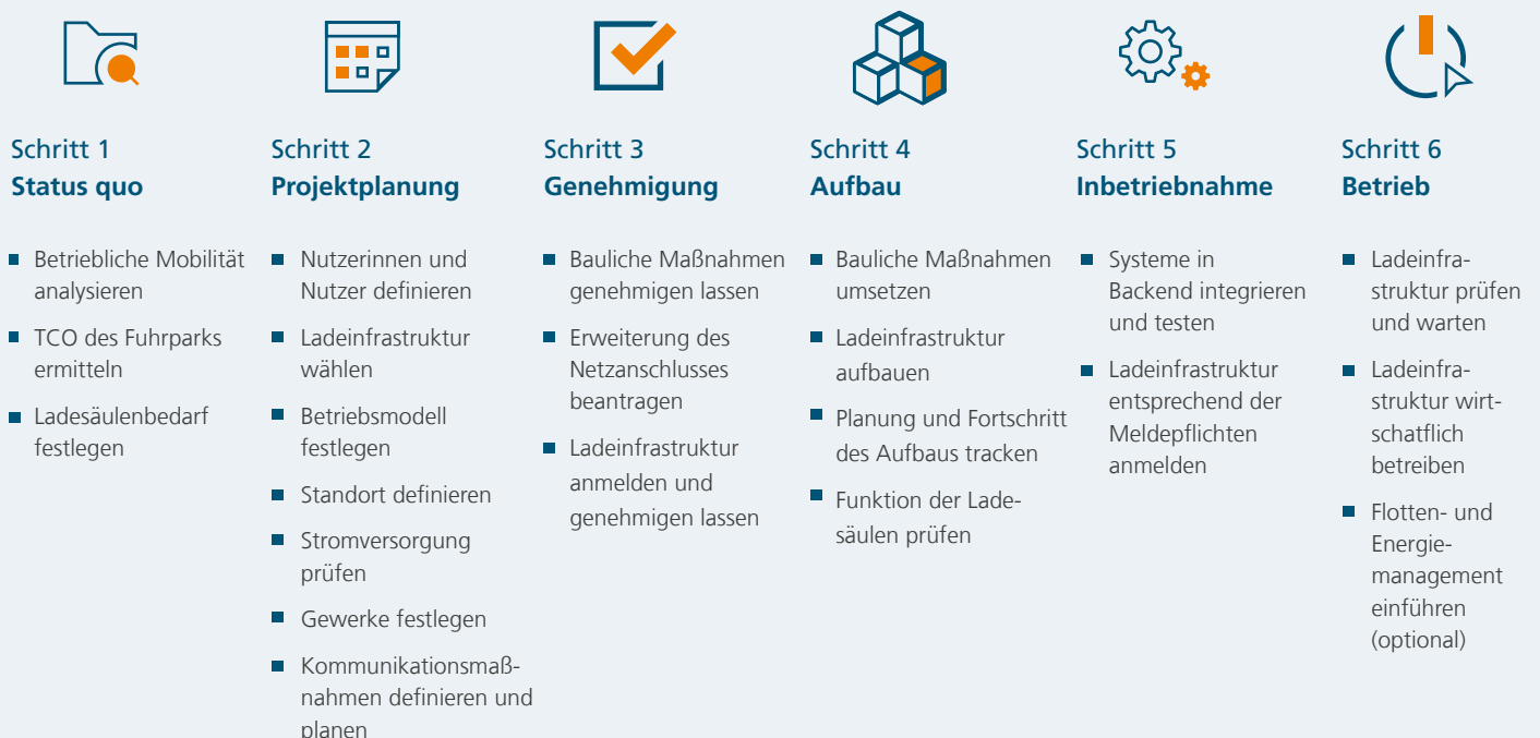
Abbildung 4: Schritte für den Aufbau der Ladeinfrastruktur.
